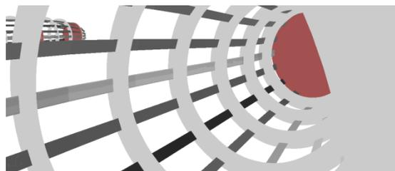
Figura 14 – Detalhe do reforçamento no interior do pontoon
