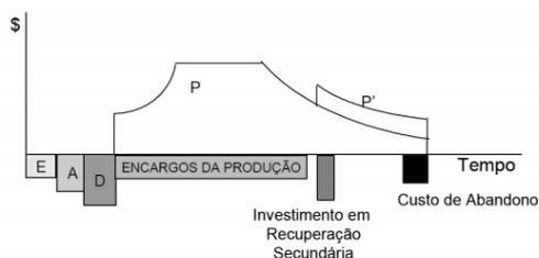
Figura 1: Fases do fluxo de caixa básico de um projeto de petróleo. Onde: E - exploração; A - avaliação; D - desenvolvimento; P - produção. O eixo vertical representa o fluxo de caixa, tendo entrada de receita e custos de investimento.
