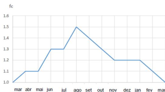
Figura 2: Coeficiente de correção de tempo de navegação, por mês.
