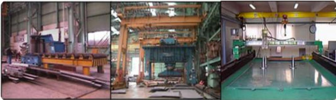
Figura 35: Recursos de conformação a frio e a quente (linhas de calor).
