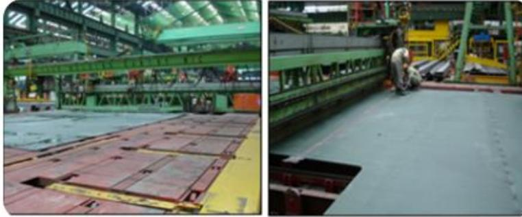
Figura 47: Processo de alinhamento e ponteamento de chapas [57].
