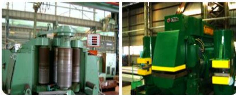
Figura 29: Prensa hidráulica vertical e Prensa hidráulica (conformação de perfis).
