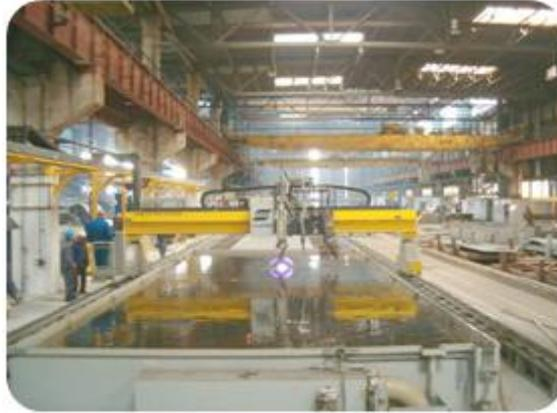
Figura 28: Estação de corte a plasma [61].
