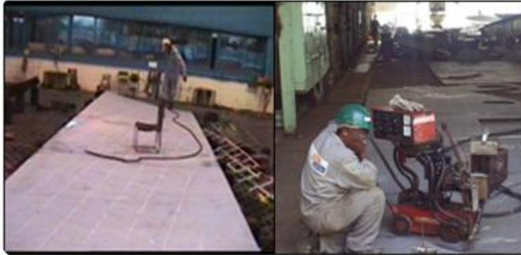
Figura 39: Processo de soldagem manual de submontagens
