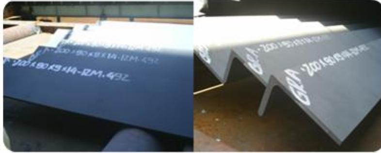
Figura 34: Exemplo de partes e perfis com anotações manuais.
